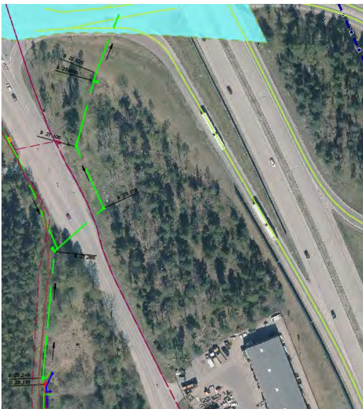
Befintlig dagvattenledning sydöst om korsningen Enköpingsvägen/Kallhällsleden.
